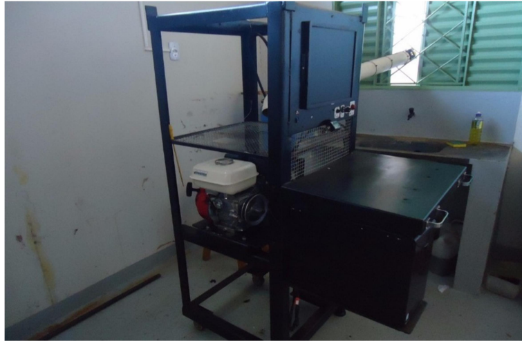
FIGURA 2 - Bancada com motor instalado
